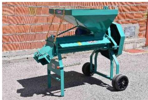
Figure 17 : Eplucheuse de fruits à coque la marque Segués
