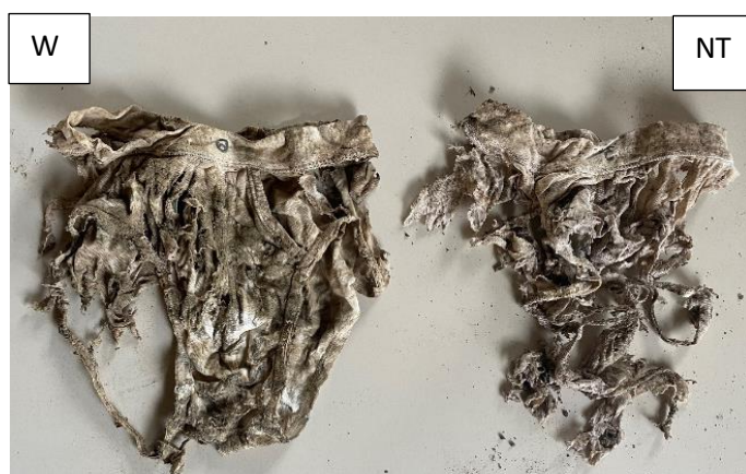
Figure 17 : dégradation des slips après 58 jours dans le sol (ci-contre)
